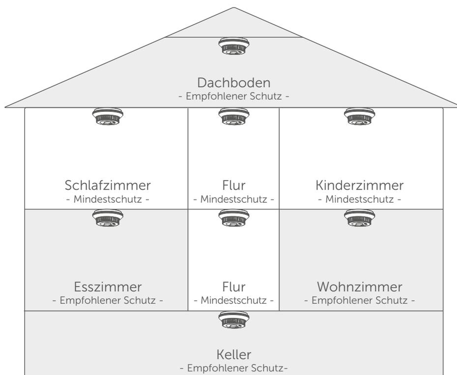
Abbildung 30: Installationshinweise Homematic IP Rauchwarnmelder mit Q-Label
